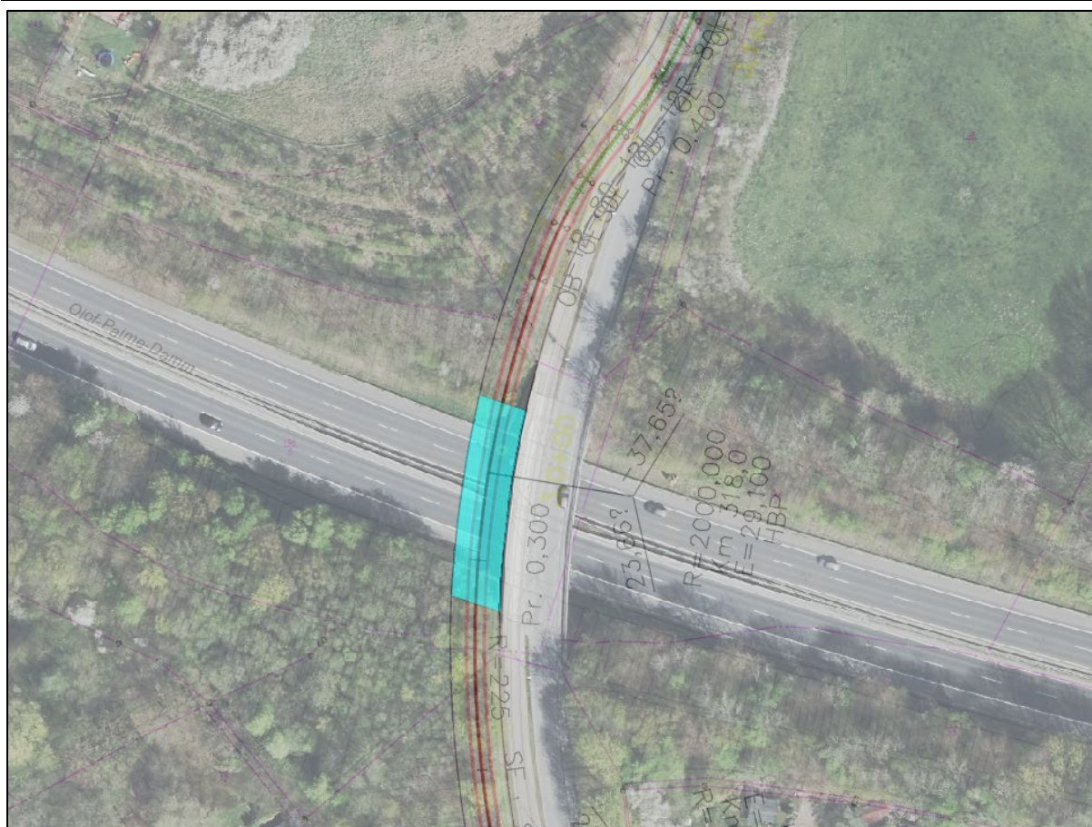
Abbildung 9 Draufsicht Trassierung des HÖV in westlicher Seitenlage
