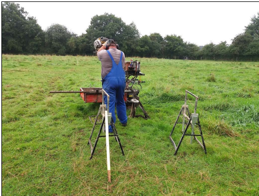
Abb. 14: Rammkernsondierungen im Teilbereich 1 – Pferdekoppel ( Firma T. Serbay, Heikendorf)
