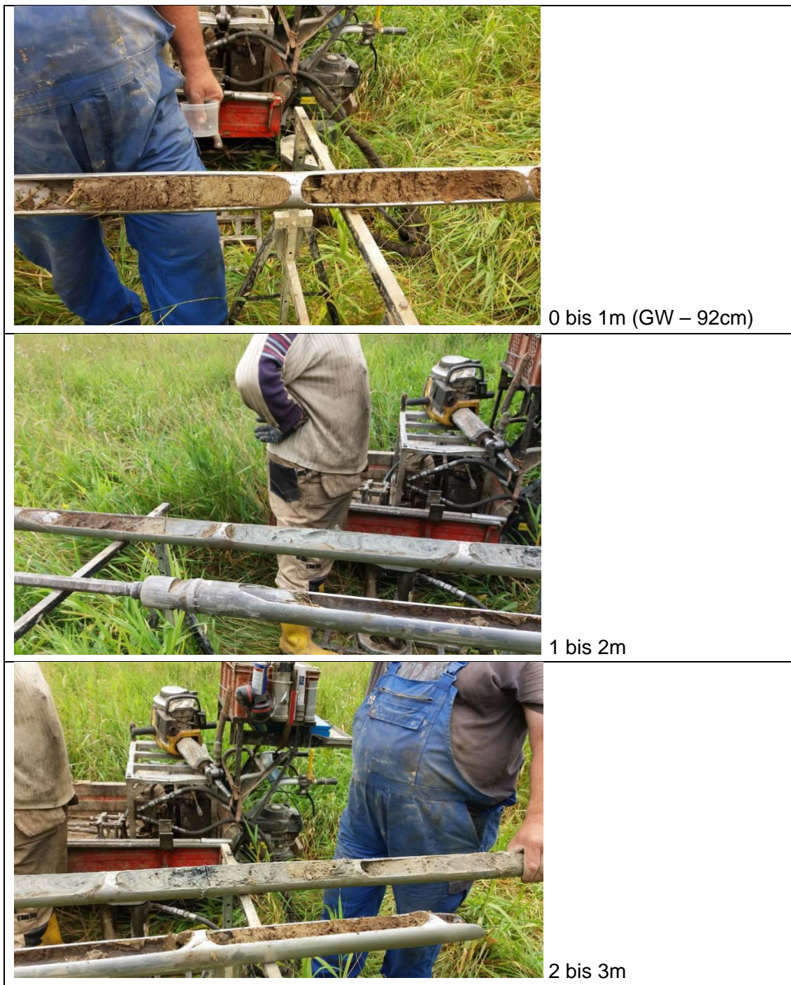
Abb. 16: Bohrsondierung Nr. 8 bis 3m Tiefe – sandiger Lehm über Mudde (Regosol-Gley über Gyttja)
