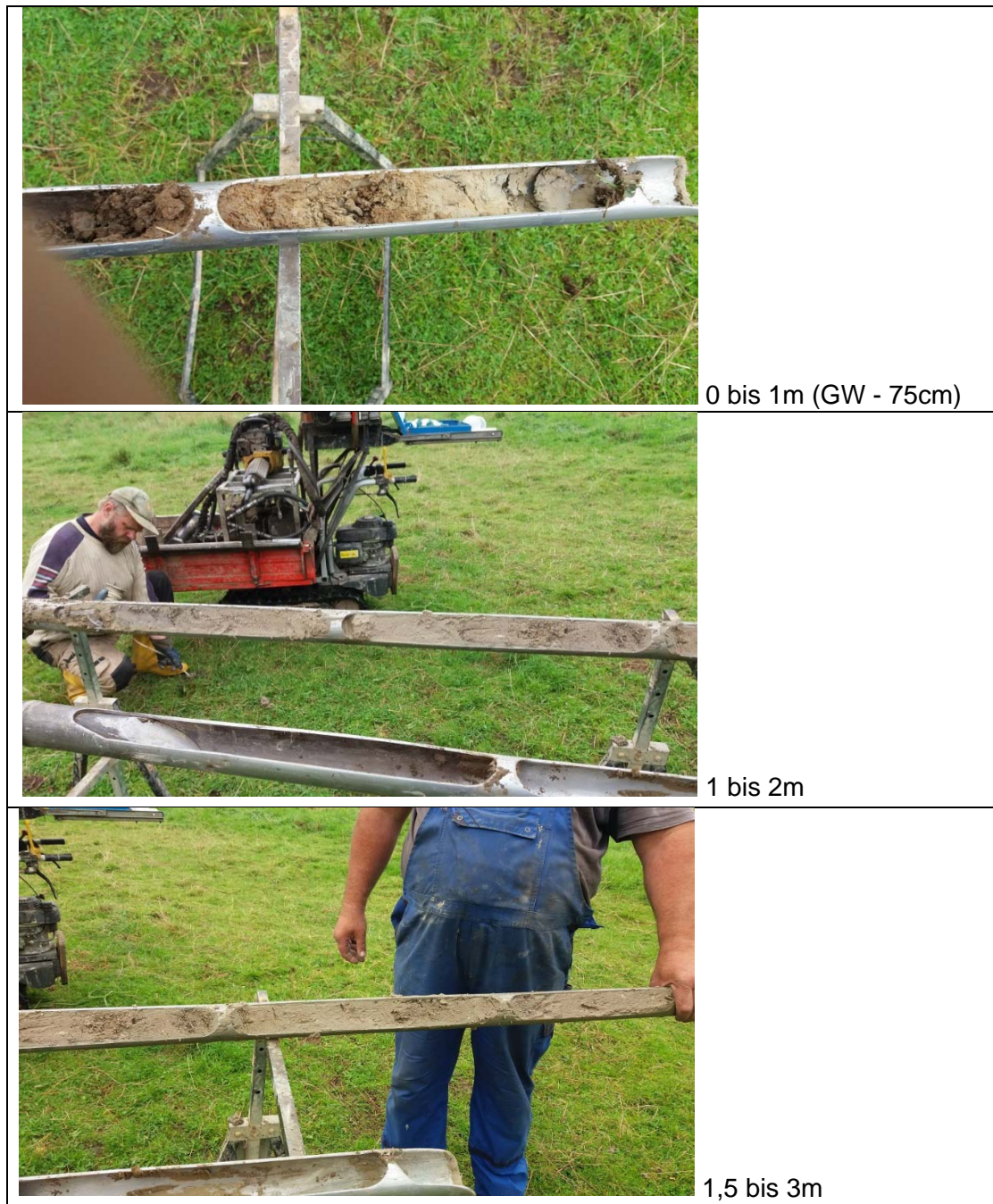
Abb. 15: Bohrsondierung Nr. 3 bis 3m Tiefe – stark sandiger Lehm über Sand (Pararendzina-Gley)
