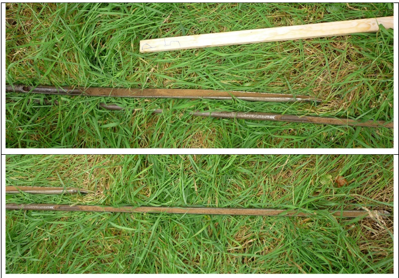
Abb. 17: Sondierung Nr. P5 bis 1,8m Tiefe – Sand, Braunerde
