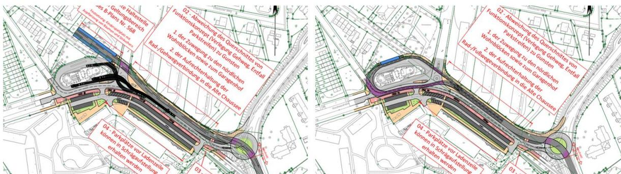
Bei den Planunterlagen im Maßstab 1:2500 wird analog zu den Planunterlagen im Maßstab 1:1000 eine Trassengeometrie, also lagefeine Führung, festgelegt. Es werden alle Kreuzungsbereiche dargestellt, jedoch ausschließlich die erforderlichen Kreuzungen detailliert geplant. Die Ausgestaltung der Nebenräume wird nicht vertieft, wenn sie nicht aus funktionaler Sicht kritisch ist, bzw. aus anderen Arbeitspaketen der konkrete Bedarf entsteht.
